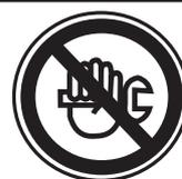
**Interdiction** : ne pas entreprendre d'intervention sur cet appareil, sans avoir débranché électriquement et sans avoir vidé le réservoir.
