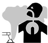
Les fumées, gaz et poussières émis par le soudage sont dangereux pour la santé. Il faut prévoir une ventilation suffisante, un apport d'air est parfois nécessaire. Un masque à air frais peut être une solution en cas d'aération insuffisante.
