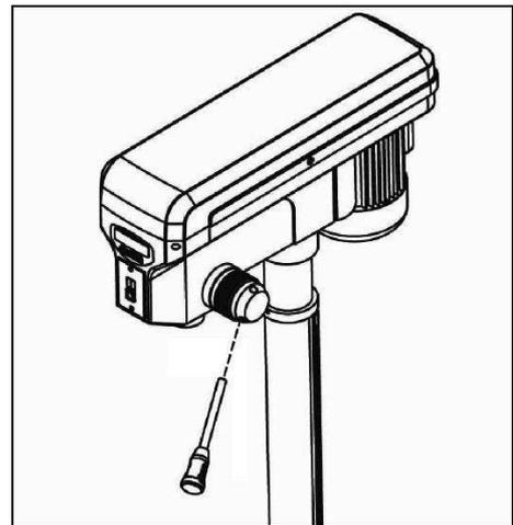
16. Connecter la lampe d'éclairage aux bornes d'alimentation.
