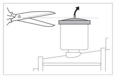
→ Avant la première utilisation couper la pointe de la couvercle du réservoir d'huile sur la pompe à eau.
