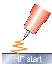
**Haute fréquence (HF) :** avec ce procédé d'amorçage, l'électrode n'entre pas en contact avec la pièce à souder. Une tension élevée d'amorçage amorce l'arc électrique. Il n'y a aucun risque d'inclusion de tungstène dans la soudure. Utilisé pour des applications de soudage de précision et de qualité élevées.
